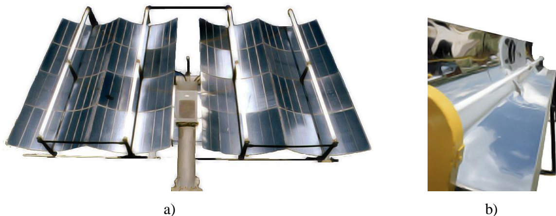
Figura 2.15 – Reatores solares cilindro-parabólicos concentradores. a) de eixo duplo (Gálvez et al. , 2001); b) de eixo simples (Gálvez & Rodríguez, 2001).
