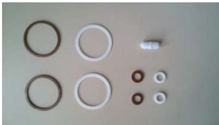
Figura 4. 3. Partes de vedação de teflon e cobre mais a barra magnética feita de núcleo de ferro envolta de um teflon.
