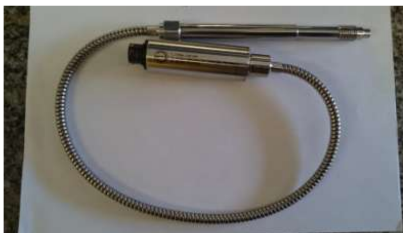
Figura 4. 4. Transdutor de pressão Gefran modelo me1-6-m-b35d-1-4-d
