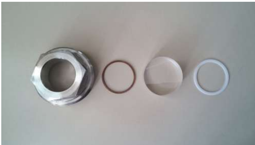
Figura 3. 8 Conexões da célula de equilíbrio, bem como anéis de vedação, anel de cobre e as respectiva janela frontal (o mesmo esquema se aplica para a janela lateral)
