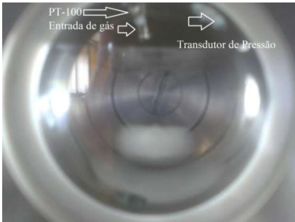
Figura 3. 10 Visão frontal da janela de safira mostrando a alimentação de CO 2 , o termopar e o transdutor de pressão.
