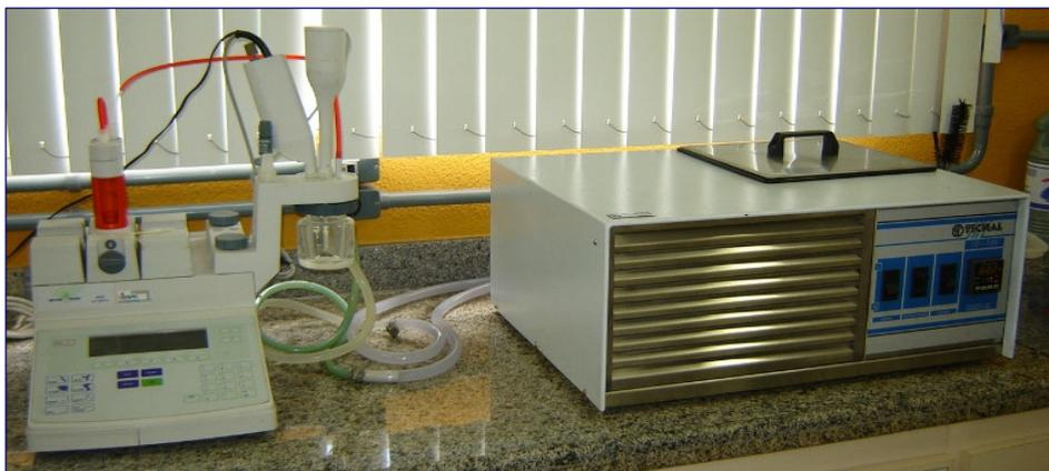
Figura 4.2 - Fototrodo Mettler Toledo DL50, equipamento utilizado nas determinações da TIAC.
