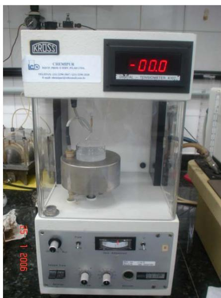
Figura 4.8. Tensiômetro Krüss para medidas de tensão interfacial.
