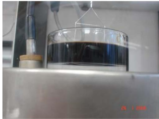
Figura 4.9. Passagem do anel pela interface entre os fluidos para determinação da tensão interfacial.
