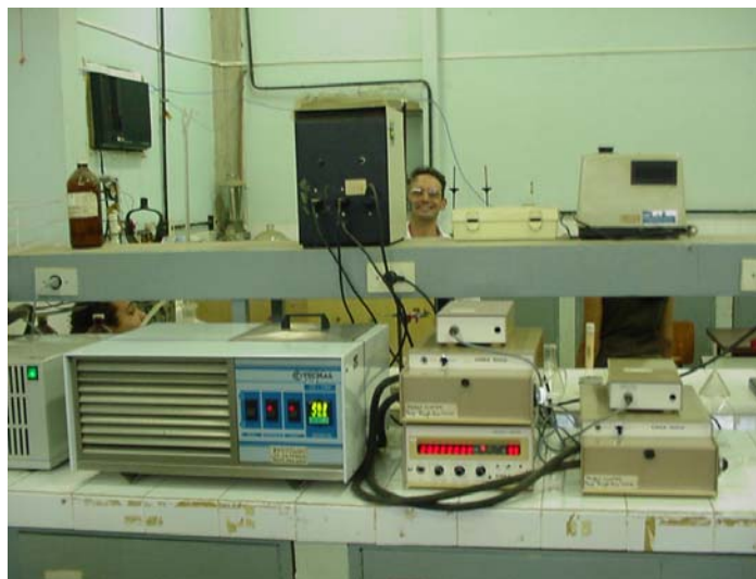
Figura 4.7. Densímetro DMA 60 acoplado ao sistema de controle de temperatura, via banho termostático
