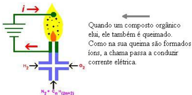
Figura 2.5. Célula de um detector ionização de chama
