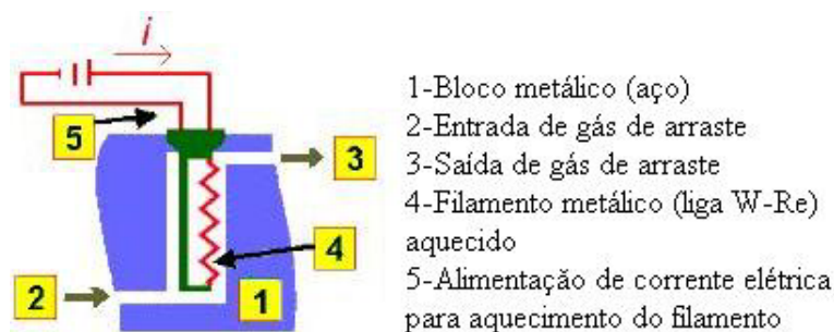
Figura 2.4. Célula de um detector de condutividade térmica
