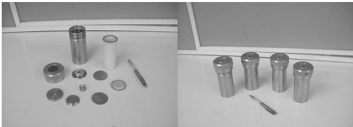
Figura 3.2. Fotografia do conjunto de peças das autoclaves utilizadas nas sínteses hidrotérmicas.
