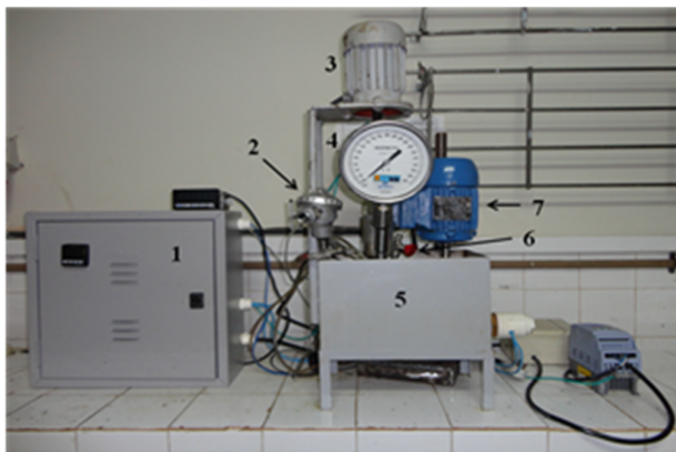
Figura 3.3 – Aparato Experimental utilizado na síntese de éteres (1-Caixa de energia; 2-PT 100; 3-Agitador (WEG NBR7084); 4-Manômetro (Makil_Classe 1 A1_0-400 bar); 5-Banho Termostático; 6- Válvula; 7-Agitação do banho (WEG NBR7084)
