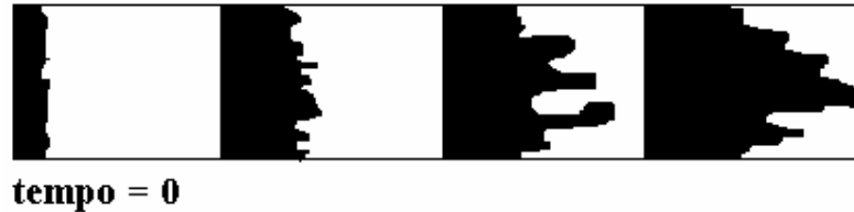
Figura II.4 - Progressão de um fluido menos viscoso através de um pacote de agente de sustentação contendo um fluido mais viscoso.
