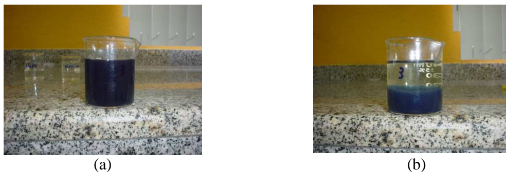
Figura 5.1. Experimento qualitativo de clarificação de efluente industrial com A-M em meio alcalino a) efluente bruto; b) efluente clarificado após coagulação e decantação.
