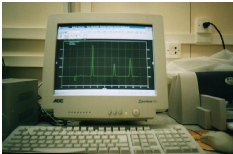
Figura 3.6: Cromatograma na tela do computador demonstrando a excelente resolução dos picos dos poluentes contidos no efluente sintético. Picos na ordem: fenol, 2,4D e 2,4-DCF, respectivamente.
