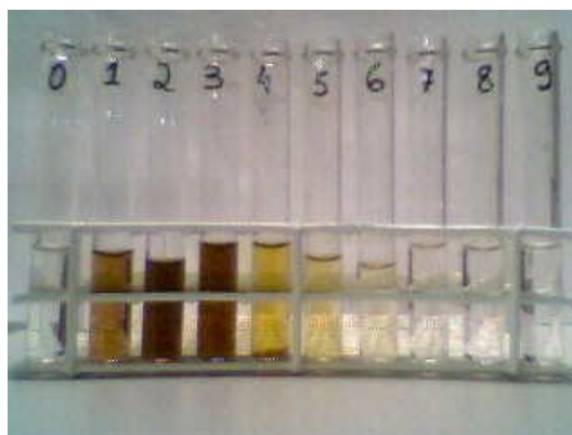
Figura 5.1: Amostras da fotodegradação do 2,4-D e precursores apresentando a variação de cor ocorrida durante o processo de tratamento. Condições de operação: \text{NaCl} = 60 \text{ g.L}^{-1} ; \text{Fe} = 2,5 \text{ mM} ; \text{H}_2\text{O}_2 = 400 \text{ mM} ; \text{pH}_0 = 7 .
