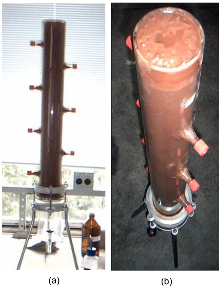
Figura 22. Coluna de experimentos empacotada com argila contaminada artificialmente com LAB. (a) Vista frontal (b) Vista superior após adição dos reagentes de Fenton.
