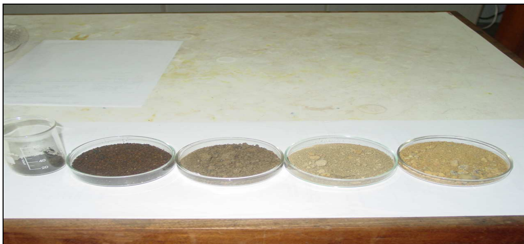
Figura 48. Foto ilustrativa do solo arenoso tratado com os reagentes de Fenton. Da esquerda para a direita nas placas de petri: solo original contaminado com LAB e solos após o tratamento, do fundo da coluna, do meio da coluna do topo da coluna, respectivamente.
