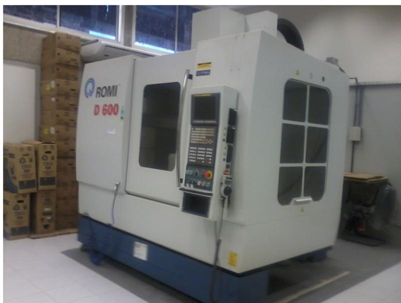
Figura 1 – Centro de Usinagem - D600 (ROMI) – Utilizada para fresamento do ferro fundido branco.
