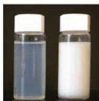
**Figura 01** – Foto de uma nanoemulsão (à esquerda) e uma macroemulsão (à direita) com tamanho de partícula de 35nm e 1µm, respectivamente.
