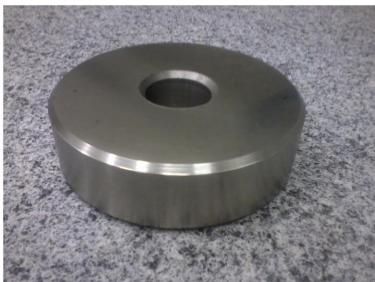
Figura 2 – Ferro fundido branco alto cromo. Material a ser usinado.
