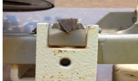
Figura 2: Faca sobre Cutelo em balança analógica
