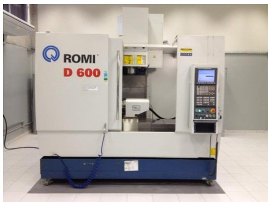
Figura 2 - Centro de Usinagem Vertical ROMI D600 (Laboratório de oficina Mecânica NTI - UFRN)
