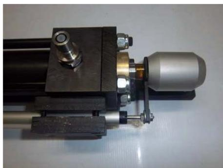
Figura 12 – Sistema Sensor-Atuador Montado.
