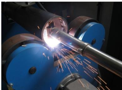
Figura 1. Soldagem realizada pelo processo PTA-P.
