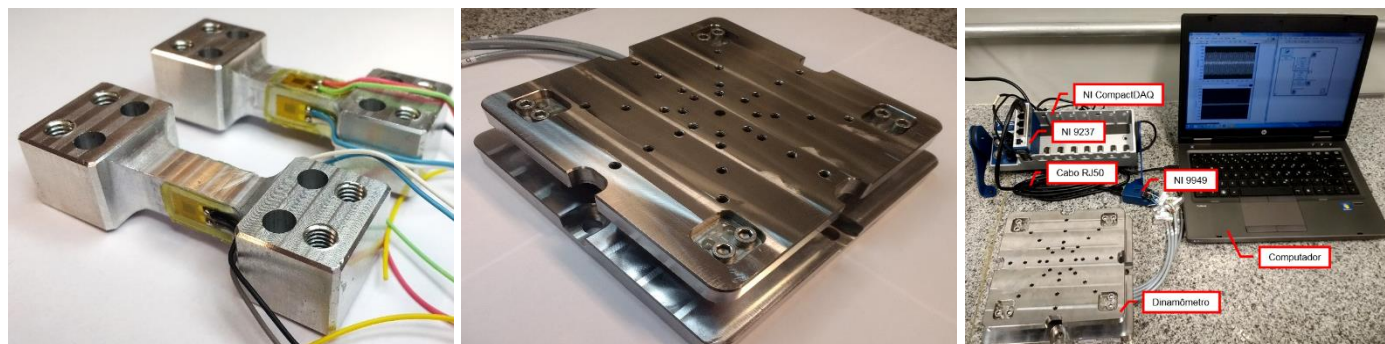
Figura 1 – Elementos elásticos com os transdutores (a), montagem do sistema finalizada (b) e sistema de aquisição de dados (c).
